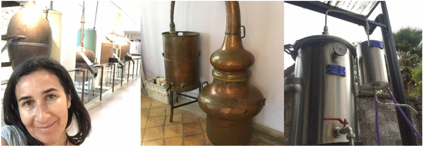
FOTO 2: Diferentes tipos de Alambiques, antiguamente eran muy comunes los de cobre, actualmente la norma exige el uso de alambiques de acero inoxidable para extraer aceites esenciales e hidrolatos de uso en cosmética, alimentario y científico.
